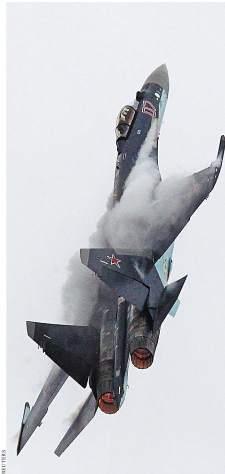
Су-35 — сверхманевренный истребитель с двигателями с управляемым вектором тяги.
