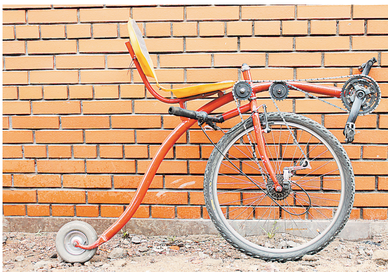
Велосипед «Паук». Длина — 1,60 м, вес — 11 кг, переднее колесо — 26 дюймов, заднее — 8 дюймов; 24 передачи, руль под сиденьем, сиденье со спинкой. Переднее колесо и ведущее, и управляемое (обычно у велосипедов ведущее заднее). Развивает скорость до 35 км/час.
