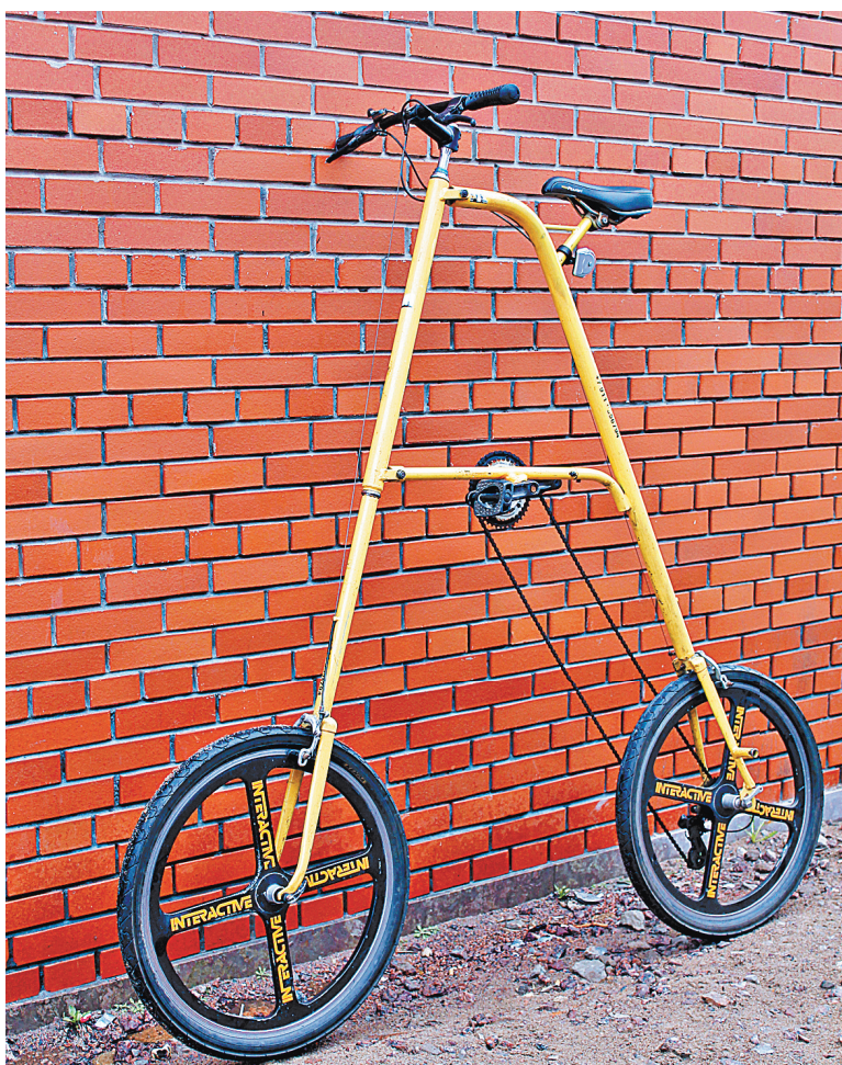
Велосипед «Желтый ангел». Высота — 1,90 м (получается, велосипедист выше водителей автобусов и грузовиков, его отовсюду видно), вес — 23 кг, колеса — 26 дюймов как обычно у горного велосипеда; колеса карбоновые, рама стальная. Скорость — до 40 км/час. Игорь признается, что любит ездить на нем быстро, всех обгонять. Встречных и обгоняемых водителей это не только не раздражает, напротив, приветствуют его улыбками.
